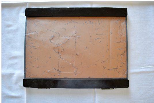
FIGURA 3: Piano di gomma con fogli lucidi per realizzare disegni in rilievo
