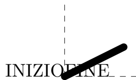
FIGURA 1: Risultato del codice LuaT E X riportato nel testo in cui il codice Lua per l’inserimento diretto di un nodo di tipo pdf_literal è inserito tra due parole. Per maggiore chiarezza sono state aggiunte due linee tratteggiate sugli assi coordinati e l’ingrandimento rispetto alle dimensioni originali.
